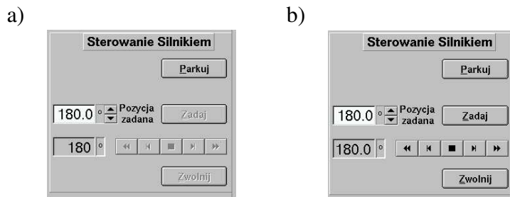
Rys. 2: Widok panelu sterowania silnikiem przed synchronizacją i po jej wykonaniu.
