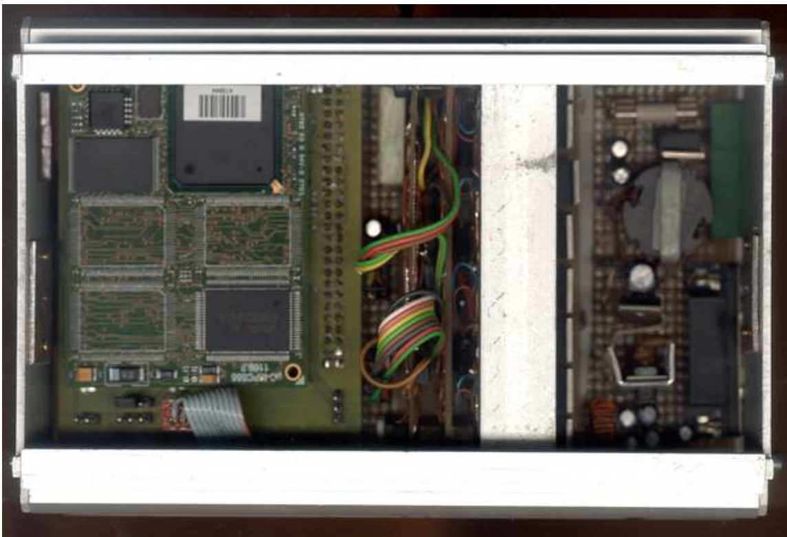
Rysunek 3: Widok obu stron płytki przejściowej sterownika
